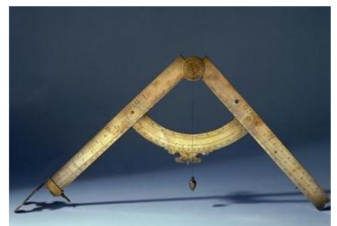
Compass of Galileo's proportion (Istituto e Museo di Storia della Scienza, Firenze).
